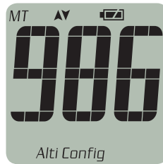
Azzeramento al suolo manuale (gli indicatori ALTI e le frecce lampeggiano)
