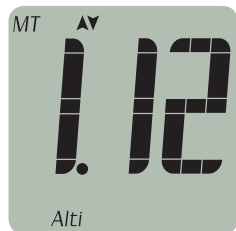
Visualizzazione al di sotto della quota di fine lavoro (l'icona ALTI e le frecce lampeggiano)
