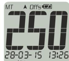
Modalità GROUND con un offset di quota impostato con una zona di atterraggio a +250 m rispetto a quella di decollo
